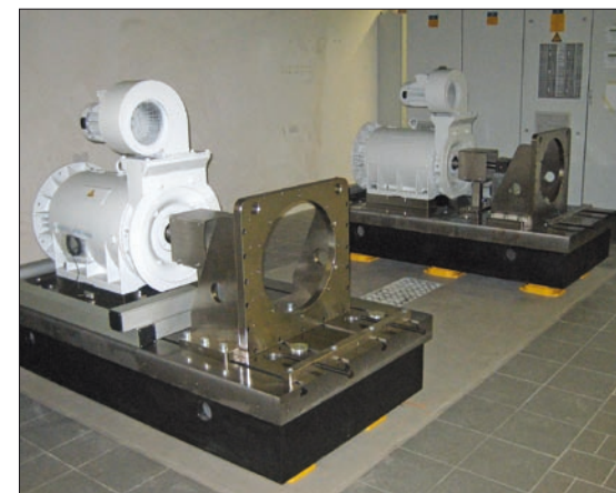
5: Doppelprüfstand für den synchronen Test von Radnabenmotoren.
