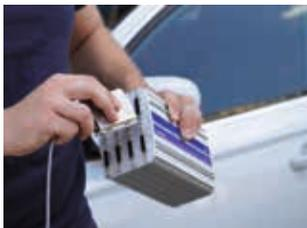
即使是极端恶劣的环境中，imc的坚固系统也可在行驶测试中可靠工作。我们的测试系统十分适合道路试验，完整集成多种功能：具有黑匣子功能、可独立PC运行、扩展工作温度范围、抗冲击与耐振动，并精确采集不同传感器的各种信号、提供稳定电源、简单快速连接，以及同步采集CAN、LIN、Flexray等总线数据。测量系统采用模块化的结构，如：imc CRONOSflex, 由于其分布式模块可靠近传感器放置，从而获得高品质的信号。
